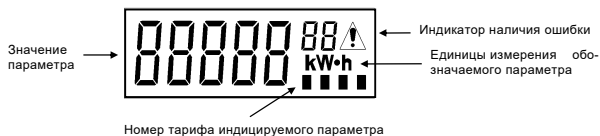
Рис. 2.1 Расположение информации на ЖКИ
